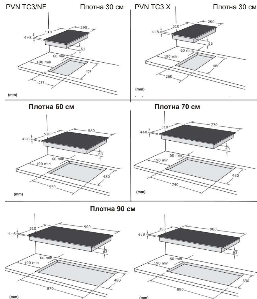
Апаратот може да биде поставен во сите видови на елементи кои имаат отпорност на екстра температури од најмалку 65°C над собната температура (EN60335 – 2 – 6). Избегнувајте инсталирање на апаратот во близина на запалливи материјали, на пример завеси, крпи и др.
