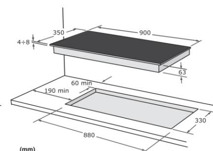
Uredaj može biti montiran u sve tipove zidnih jedinica koje su otporne na temperaturu koja je najmanje 65° C iznad sobne temperaturu (EN 60335 - 2 - 6). Izbegavajte instaliranje u blizini zapaljivih materijala na primer zavesa, odeće itd.
