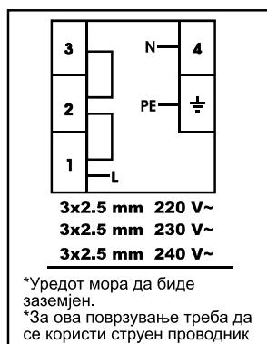
За стаклокерамичката плоча за готвење, кабелот мора да биде H05VV-F 3X2,5 mm<sup>2</sup> / 60227 IEC 53. На задниот дел на уредот ќе го најдете дијаграмот на поврзување.
