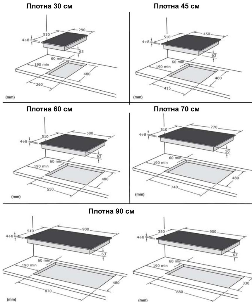
Апаратот може да биде поставен во сите видови на елементи кои имаат отпорност на екстра температури од најмалку 65°C над собната температура (EN60335 – 2 – 6). Избегнувајте инсталирање на апаратот во близина на запалливи материјали, на пример завеси, крпи и др.
