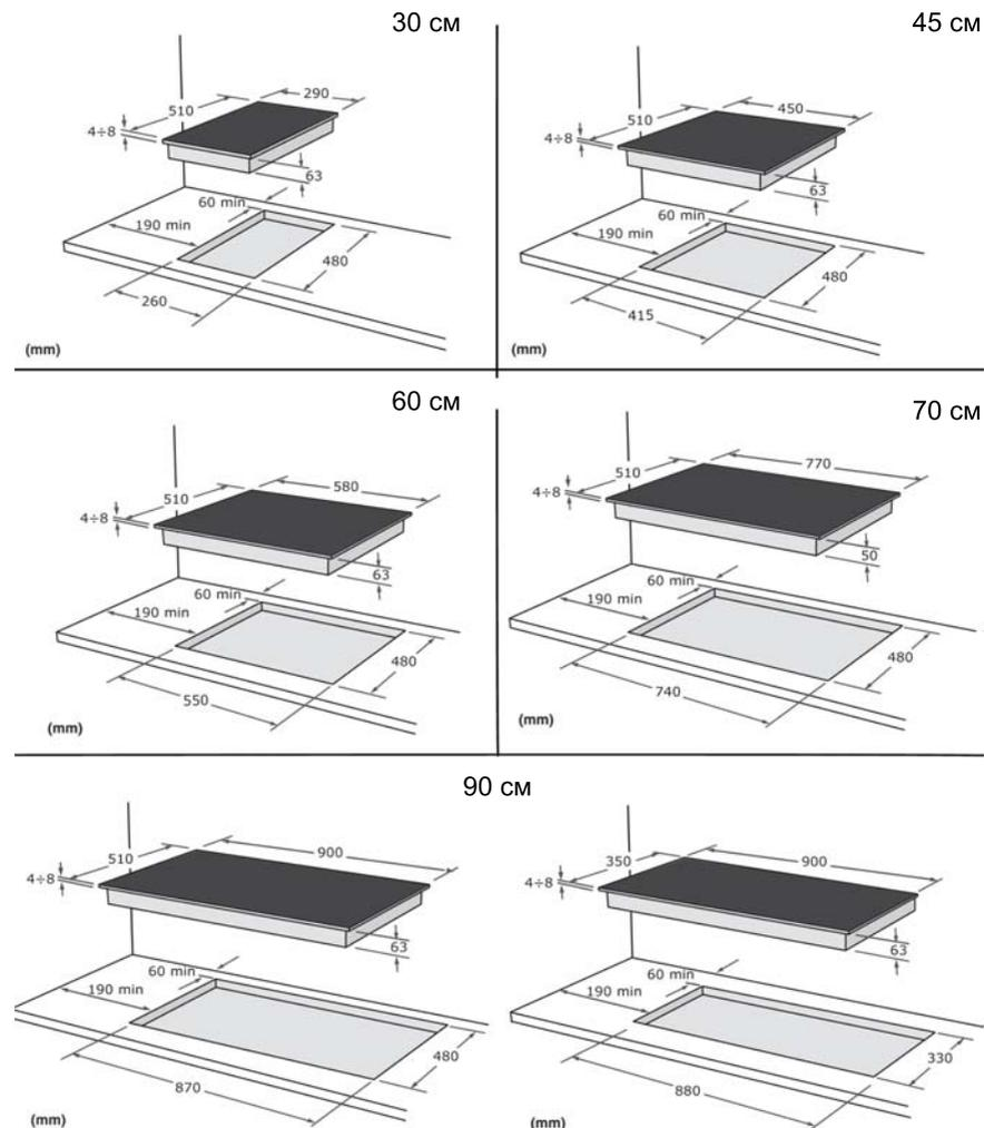
Uređaj može biti montiran u sve tipove zidnih jedinica koje su otporne na temperaturu koja je najmanje 65° C iznad sobne temperature (EN 60335 - 2 - 6). Izbegavajte instaliranje u blizini zapaljivih materijala na primer zavesa, odeće itd.
