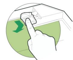
Заключване на контролния панел : възможно е да заключите контролния панел, например, когато почиствате стъклата. Моторът и осветлението трябва да са изключени.
