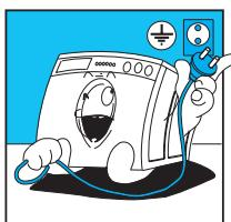
*La lavadora debe conectarse a una toma de corriente eléctrica provista de puesta a tierra y conforme a las exigencias de seguridad.*
