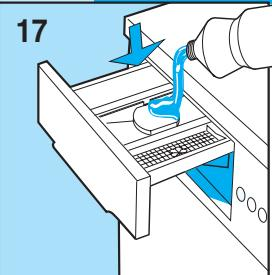
Remarque: Quand on utilise du détergent liquide (recommandé pour les programmes sans prélavage), il faut mettre le récipient prévu à cet effet (si disponible) ou la cloison dans le bac intermédiaire "2" (voir illustration ci-contre), fig. 17/18 et verser le détergent jusqu'au niveau indiqué.
