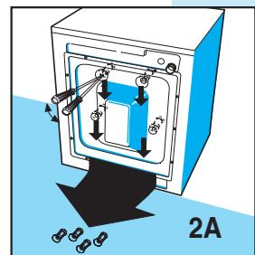
Introducir en los orificios un destornillador y operar como se indica en la figura para poder recuperar los 4 separadores de plástico.
