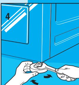
Depois de ter decidido o sítio em que deseja montar a máquina, coloque a máquina perfeitamente horizontal, utilizando os pés reguláveis (Fig. 4). Dedique especial atenção à escolha da posição, à nivelamento da própria máquina e à segurança das contraporcas.
