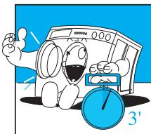
**Al termine del lavaggio è necessario attendere tre minuti circa prima di poter aprire l'oblò, in quanto sull'apertura è posto un dispositivo di sicurezza che vi protegge da aperture accidentali.
