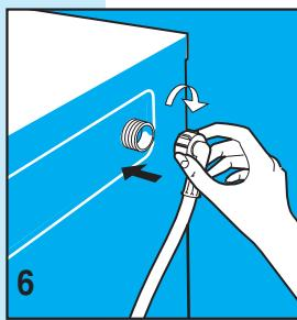
**N.B.** Nelle lavabiancheria elettroniche dotate di doppia elettrovalvola (acqua calda e fredda), collegare il tubo rosso al rubinetto di acqua calda e, l'altro tubo al rubinetto di acqua fredda. In caso non fosse possibile utilizzare un rubinetto di acqua calda, i due tubi dovranno essere collegati entrambi a quello di acqua fredda, tramite l'apposito raccordo in dotazione (vedi fig.5A)
