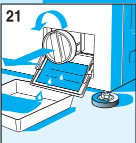
**ATENÇÃO !!** Antes de começar a fazer as operações descritas abaixo, assegure-se de que a máquina está vazia. Não tire o filtro durante o funcionamento da máquina ou quando esta estiver cheia de água.
