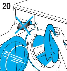
La structure externe et les parties en plastique de la machine à laver le linge doivent être nettoyées uniquement au moyen d'un chiffon doux humide.
