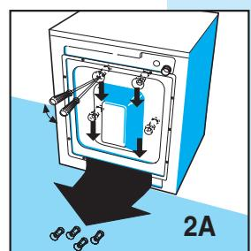
Inserire nei fori un giravite e agire come in figura per poter recuperare i 4 distanzieri in plastica.
