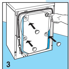
Per motivi di trasporto il gruppo oscillante della macchina viene bloccato da 4 distanzieri con viti. Prima di mettere in funzione la macchina togliere le viti di bloccaggio con una chiave.
