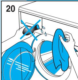
La estructura externa y las partes de plástico de la lavadora deben limpiarse solamente con un paño suave húmedo.
