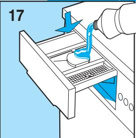
**N.B.** Cuando se usa el detergente líquido (recomendado para programas sin prelavado), introducir el contenedor especial (si previsto) o el tabique en la cubeta intermedia "2" (en el modo que se ilustra al lado), fig. 17/18 luego vaciar el detergente líquido hasta el nivel máximo indicado.
