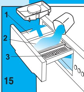
La machine à laver le linge est équipée d'un secteur pour détergent à trois cuvettes:
