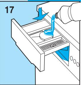
**N.B.** Quando si usa il detersivo liquido (raccomandato per programmi senza prelavaggio), inserire lo speciale contenitore (se previsto) o la paratia nella vaschetta intermedia "2"(nel modo mostrato a lato), fig. 17/18 versare quindi il detersivo liquido fino al livello massimo indicato.
