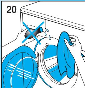
A estrutura exterior e as partes de plástico da máquina devem ser limpas exclusivamente com um pano húmido macio.
