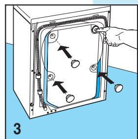
Por motivos de transporte el grupo oscilante de la máquina está bloqueado con 4 separadores con tornillos. Antes de hacer funcionar la máquina quitar los tornillos de bloqueo con una llave.
