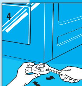
Dopo aver scelto il posto adatto, regolare bene in piano la macchina utilizzando i piedini regolabili (Fig. 4). Porre particolare attenzione alla scelta della posizione, al livellamento della lavatrice stessa ed alla sicurezza dei controdadi.
