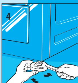
Después de haber seleccionado el lugar adecuado, nivelar bien la máquina usando los pies regulables (Fig. 4). Poner particular atención al seleccionar la posición, en nivelar bien la lavadora y en la seguridad de las contratueras.
