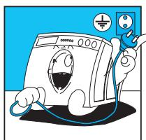
**La lavatrice deve essere collegata ad una presa di corrente elettrica provvista di messa a terra e conforme alle esigenze di sicurezza.**
