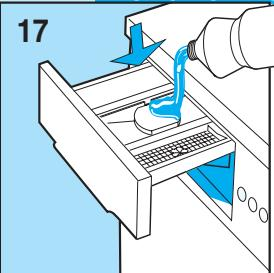
**NOTA:** Quando utilizar detergente líquido (recomendado para programas sem pré-lavagem), introduza o recipiente especial (se disponível) ou a divisória no compartimento do meio, "2", da gaveta (conforme representado ao lado), fig. 17/18, e adicione a seguir detergente líquido, até ao nível máximo indicado.
