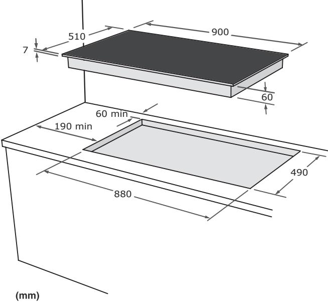
O aparelho pode ser encaixado em todos os tipos de móveis cujos muros resistem a uma temperatura de pelo menos 65 °C para além da ambiente (EN 60335 - 2 - 6). Evitar a instalação nas imediações de materiais inflamáveis, tal como cortinados, trapos, etc.
