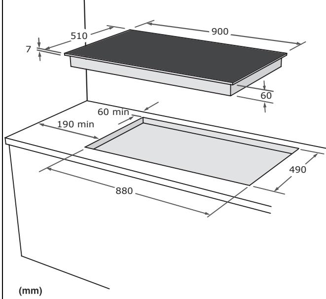
El aparato puede ser empotrado en todos los tipos de muebles cuyas paredes resistan a una sobre temperatura de por lo menos 65 °C, superior a la del ambiente (EN 60335 - 2 - 6). Evitar de instalarlo cerca de materiales inflamables por ejemplo cortinajes, cañamazos, etc.
