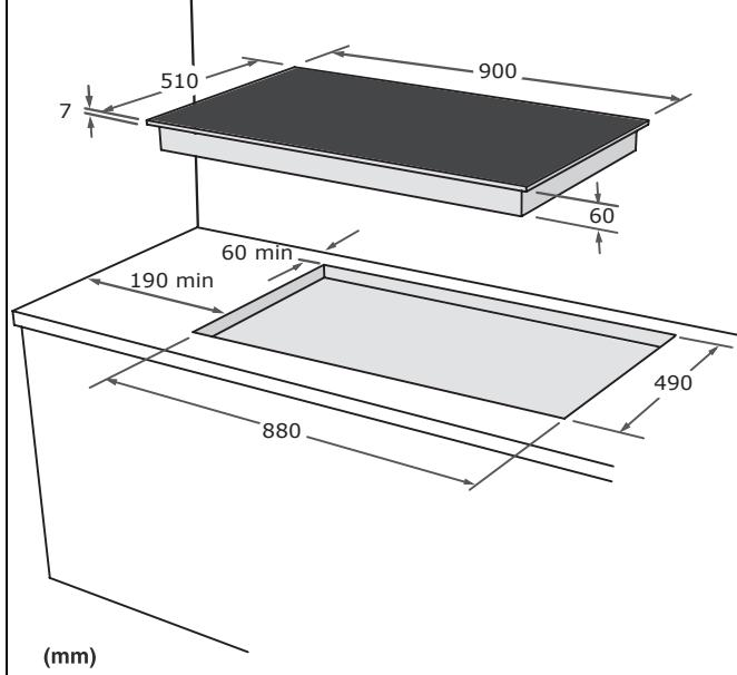
L'appareil peut être encastré dans tous les meubles dont les parois résistent à une température supérieure de 65°C au moins à celle ambiante (EN 60335 - 2 - 6). Éviter de l'installer à proximité de matériaux inflammables, par exemple, rideaux, torchons, etc.
