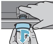
Следует использовать только самозащищающуюся вольфрамовую светодиодную лампу, LED лампу или самозащищающуюся металлогалогенную лампу.
