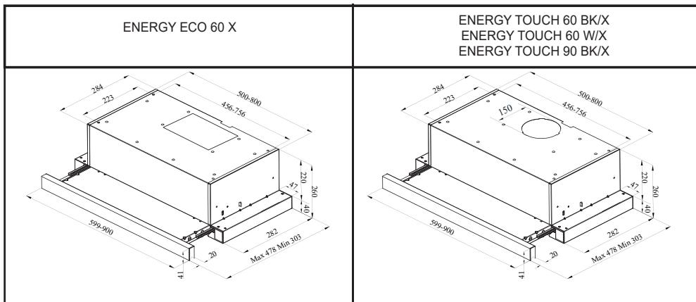
Фиг. 1 – Технически чертеж на аспиратора за всички модели
