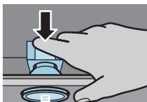
Uverite se da sijalica iskače pritiskom na sijalicu sa zadnje strane. Uklonite sijalicu okretanjem četvrtine kruga u smeru suprotnom od kazaljke na satu. (Slika 16)
