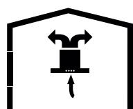
Фиг. 5 Циркулация на въздуха при филтриращ режим на работа
