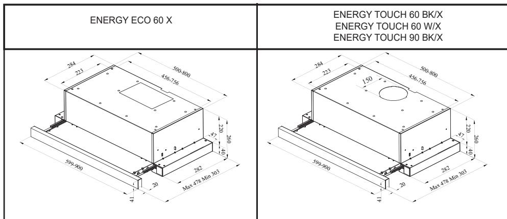
Фиг. 1 – Технический чертеж вытяжки для всех моделей
