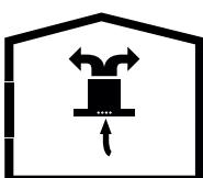
Фиг. 5 Циркуляция воздуха в режиме фильтрации
