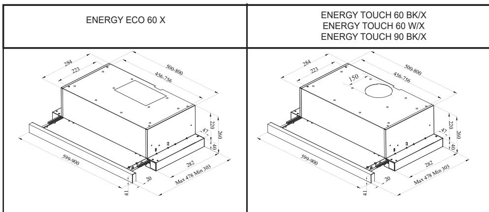
Слика 1 – Технички цртеж на аспираторот за сите модели
