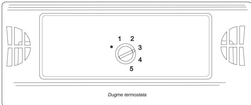
Termostat u odeljku frižidera automatski reguliše unutrašnju temperaturu odeljaka. Rotiranjem dugmeta sa pozicije 1 ka 5 mogu se dostići niže temperature.
