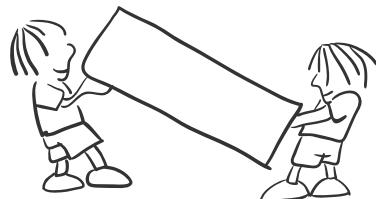
*Frižider nosite u uspravnom položaju. U slučaju da je uređaj nošen u horizontalnom položaju, potrebno je sačekati minimum 3 sata pre uključivanja, kako bi se izbegla oštećenja sistema za hlađenje.*
