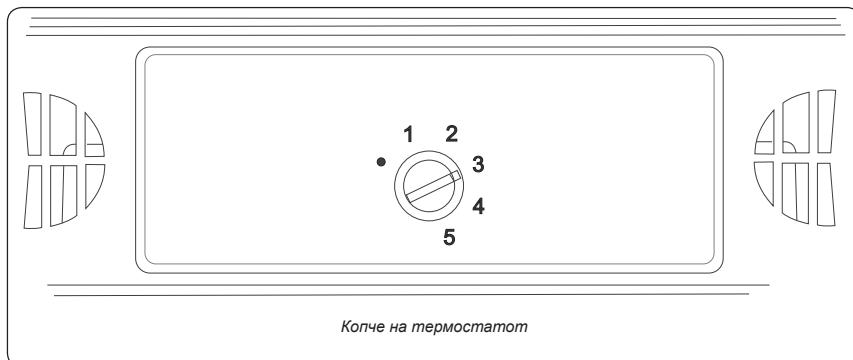
Термостатот на уредот ја регулира внатрешната температура во одделите. Со ротирање на копчето од позиција 1 до 5 може да се добијат поладни температури.
