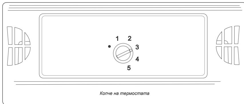
Термостатът на уреда автоматично регулира вътрешната температура на хладилника. Чрез завъртане на копчето от позиция 1 на 5 може да се постигне по-ниска температура.
