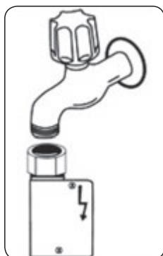
**ЗАБЕЛЕЖКА:** В някои модели се използва устройство аква-стоп. В случай на използване на аква-стоп съществува опасно напрежение. Не прерязвайте маркуча на аквастопа. Не позволявайте нагъване или усукване.
