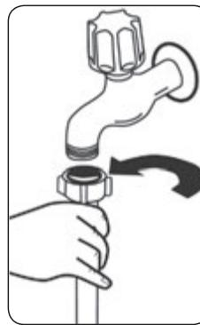
biste izbegli ulazak nečistoće u mašinu, zbog prisustva peska, zemlje, rđe i dr u vodi, što može povremeno prolaziti kroz vodovod i ili ulazne vodovodne cevi i može preduprediti zamućenje ili formiranje taloga nakon pranja.
