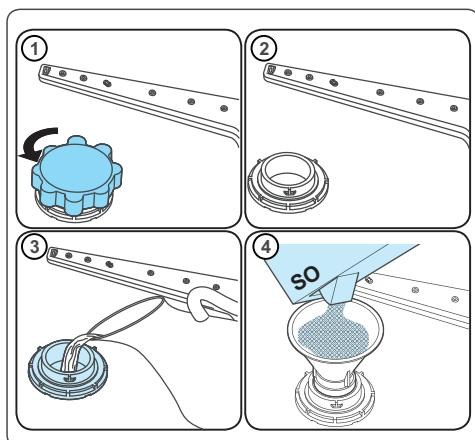
Ukoliko u odeljak za so stavite tablette za odstranjivanje kamenca, nemojte da odeljak do kraja punite vodom.
