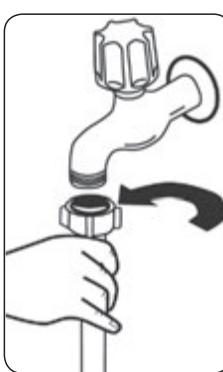
и да повреда на съдомиялната машина поради някакви замърсявания (пясък, глина, ръжда и др.), които могат случайно да се пренесат от централния или домашния водопровод и да предизвикат такива оплаквания като пожълтяване и образуване на отлагания след измиване.
