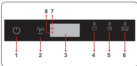
1. Копче на допир за вклучување / исклучување
