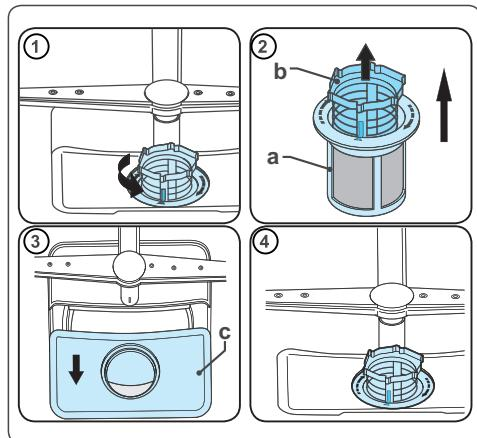
Чтобы снять и очистить блок фильтров, поверните его против часовой стрелки и извлеките, потянув вверх (1). Вытащите фильтр грубой очистки из микрофильтра (2). Затем извлеките металлический фильтр (3). Промойте фильтры большим количеством воды, чтобы на них не осталось посторонних веществ. Снова соберите фильтры. Установите на место фильтрующий элемент и поверните его по часовой стрелке (4).
