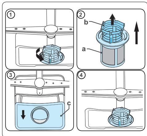
Da biste uklonili i očistili kombinaciju filtera, okrenite je u smeru suprotnom od kazaljke na satu i izvadite je podižući prema gore (1). Izvucite grubi filter iz mikro filtera (2). Zatim izvucite i uklonite metalni filter (3). Isplaknite sa mnogo vode dok se ne očiste ostaci. Ponovo sklopite filtere. Zamenite uložak filtera, i okrenite ga u smeru kazaljki na satu (4).
