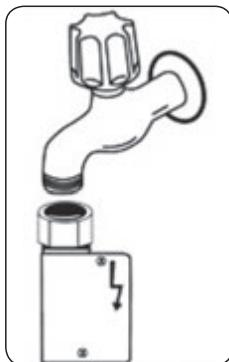
**Z A B E L E Š K A :** aqua stop ventil je uključen u nekim modelima. U slučaju korišćenja aqua stopa postoji opasna napetost. Nemojte da oštetite aqua stop ventil. Ne dozvolite da se isti presavije.
