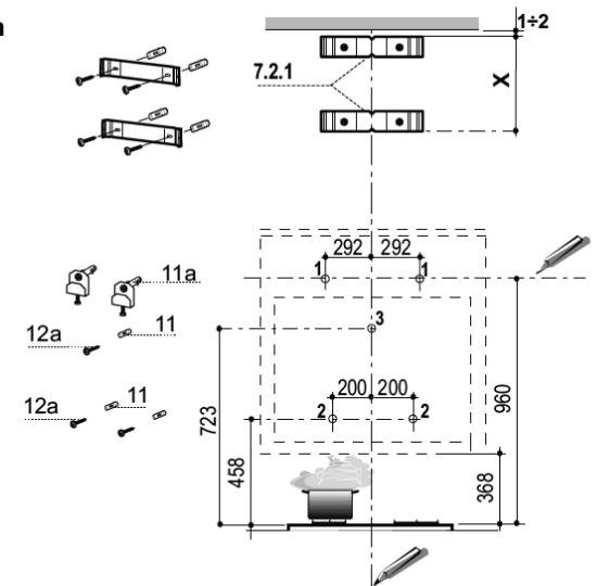
Kao prvi korak, produžite sa sledećim crtežima: Vertikalna linija pravo do plafona ili gore prema najvišoj tačci, u centru oblasti u kojoj treba biti postavljena hauba; Jedna horizontalna linija na minimumu od 960 mm iznad vrha kuhinjskog štednjaka.-
