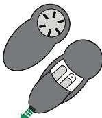
Uređajem se može upravljati pomoću daljinskog upravljača snage 1,5 V alkalne karbon/cink baterije standardnog tipa LR03- AAA tip (nisu isporučene u paketu).
