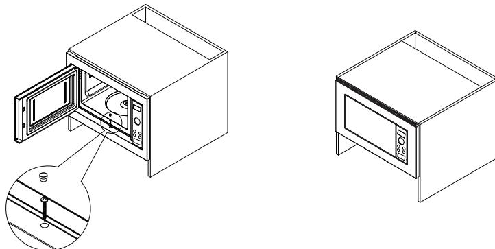
2. Otvorite mikrotalasnu pećnicu, pričvrstite zavrtanj (Komponenta 3) i zakucajte ga u kabinet, potom montirajte čiviju šrafa sa poklopcom (Komponenta 2).
