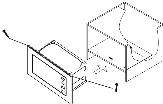
1. Postavite mikrotalasnu pećnicu u kućište i ostavite pećnicu da stoji horizontalno i ima is udaljenost od leve i desne strane kućišta, a zatim umetnите umetak kao što je prikazano na dijagrameu (Komponenta 1).
