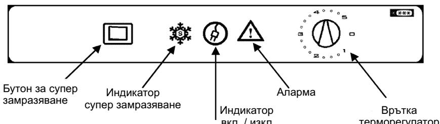
Терморегулатора на фризера автоматично регулира вътрешната температура на отделенията. Чрез въртенето на врътката от позиция 1 до 5 се постига по-студена температура. Позиция "0" означава, че терморегулаторът не е включен и няма охлаждане.
