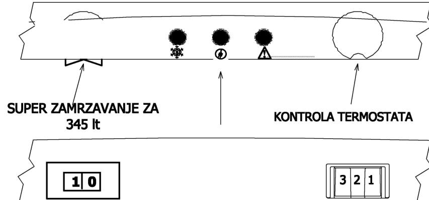
Termostat u zamrzivacu automatski regulise temperaturu u zamrzivacu. Okretanjem prekidača može se regulisati temperatura.
