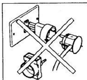
**! PA NJA** Uzemljenje aparata je obavezno. Ukoliko ne koristite uto zeleni kabel mo ete izazvati rizik od elektriennog udara.
