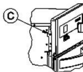
U sluèaju popravke ili promene neophodno je za delove koji su napisani na tabeli (na primer programator) da se demontira zadnji ili gornji panel, moete ga odstraniti kada æete izvaditi dugmiæe i odvijete šrafove sa obe strane panela. Nakon toga izvucite panel vertikalno prema vama.
